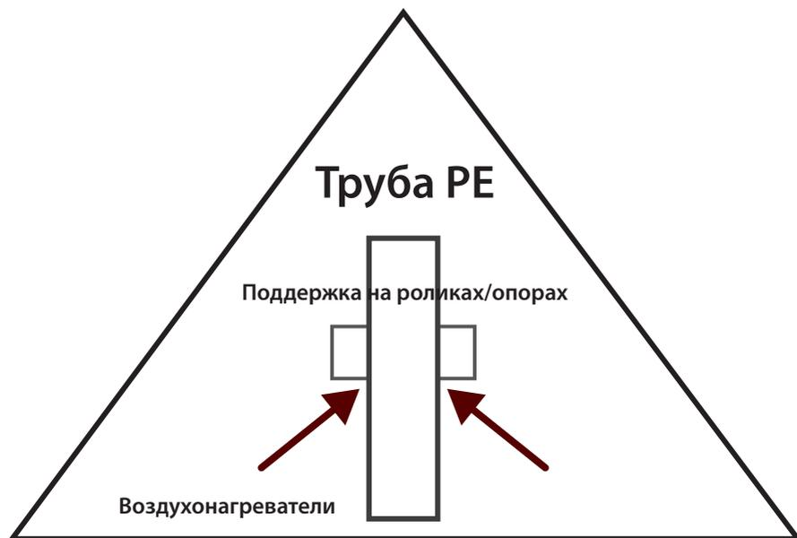
Рисунок 1 – Схема подогрева трубы
